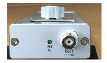
Der Abhörverstärker AV19i ist primär zum Abhören von Luft- und Körperschall über einen am Ausgang anzuschließenden Kopfhörer gedacht.
