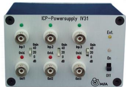
3-Kanal IEPE-Speisegerät mit Verstärkung
