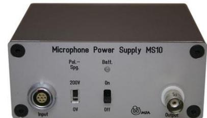
Die batteriebetriebenen Speisegeräte der Baureihe MSxx und MVxx liefern 0 V oder 200 V Polarisationsspannung für Kondensatormikrofone und 30 V bzw.  $\pm 15$  V für Vorverstärker. Sie sind somit für eine große Anzahl handelsüblicher Kondensatormikrofone geeignet. Die Speisegeräte sind auf geringstes Eigenrauschen optimiert.
