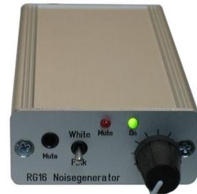
Die Rauschgeneratoren RG16 wurde speziell für den Einsatz in der Bauakustik entwickelt und ist sehr handlich und leicht. Er erzeugt weißes und rosa Rauschen.
